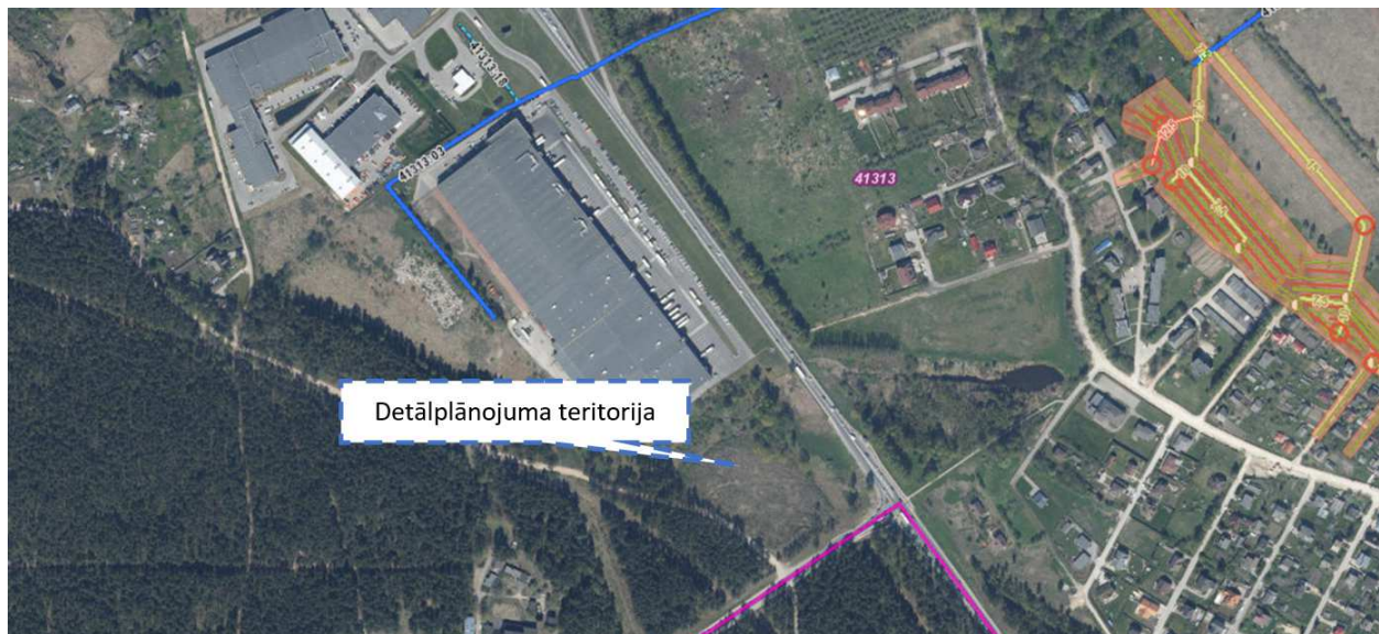
7. attēls. Tuvumā esošās meliorācijas sistēmu teritorijas, t.sk. ūdensnotekas (attēlā ar zilās krāsas līniju) Avots: Meliorācijas kadastra informācijas sistēma, tīmekļa vietne: melioracija.lv
